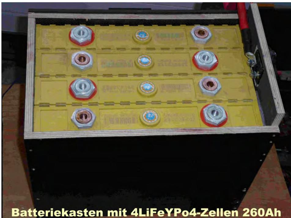
**Batteriekasten mit 4LiFeYPO<sub>4</sub>-Zellen 260Ah**
