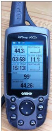
Um die jeweilige Höhe zu bestimmen hat man mit dem Garmin 60CSx zwei verschiedene Möglichkeiten. Entweder die barometrische Höhenmessung oder wie in unserem Falle durch Auswertung der GPS Daten die gleichzeitig von mehreren Satelliten durch das Gerät empfangen wurden. Die ununterbrochen vom Garmin empfangenen Daten werden im internen Speicher abgelegt und können bei Bedarf dort abgerufen werden.
